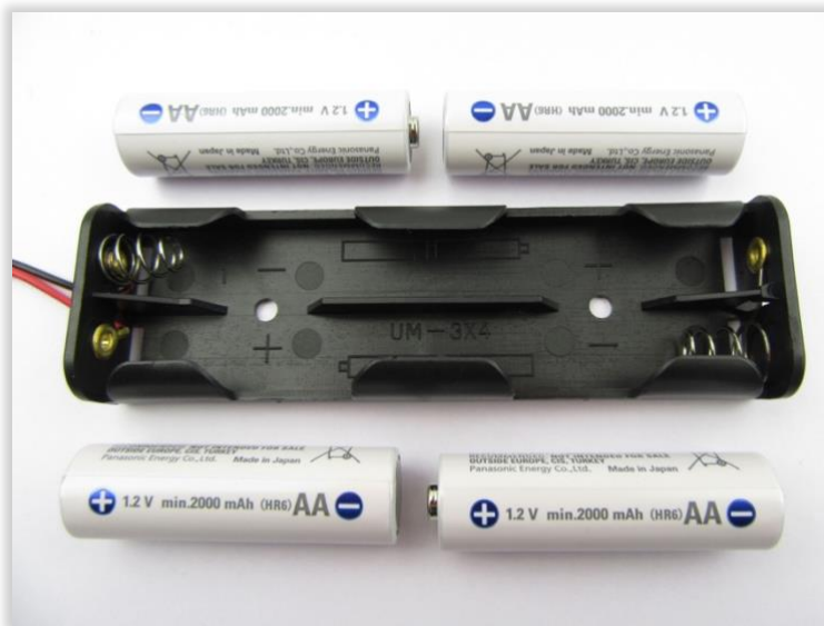
Figure 4 - Polarité des accumulateurs
